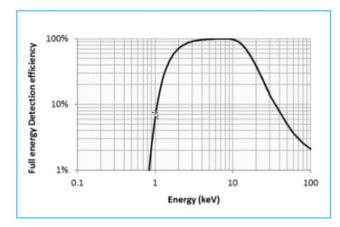
Figure 1. Courbe d'efficacité calculée pour le détecteur X-PIPS™ avec une fenêtre Be de 1 mil et silicium de 500 μm.
