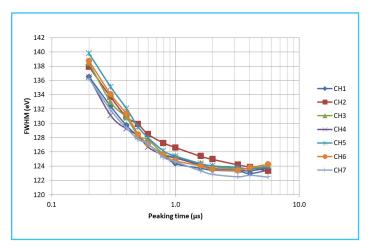
Figure 2. Résolution énergétique type (FWHM 5,9 keV Mn-Ka) en fonction du temps de pic pour un réseau SDD à 7 éléments. Le taux de comptage entrant était de 10-15 kCPS.
