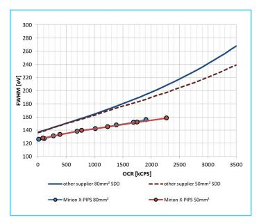
Figure 3. Mesures type à taux de comptage élevé sur un canal d'un système à 7 éléments pour une surface active de 50 ou 80 mm² par élément. La comparaison avec un autre fournisseur de SDD est également présentée.
