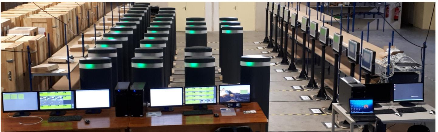
Exemple du système de surveillance d'un aéroport ( dans l'usine ) : 31 unités SPIR-Ident Pedestrian connectés à 12 postes d'alarme locaux, 2 postes d'alarme centraux (en bas à gauche), 1 serveur de données (en bas à droite).
