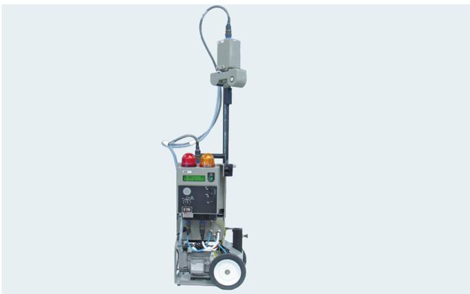
Moniteur mobile aérosols alpha/bêta ABPM 203M™. Ce moniteur, avec son capteur extensible petit et léger, fonctionne localement à côté des voies respiratoires des travailleurs. Il est parfaitement adapté à la mesure des particules dans les environnements présentant des taux élevés de radon.
