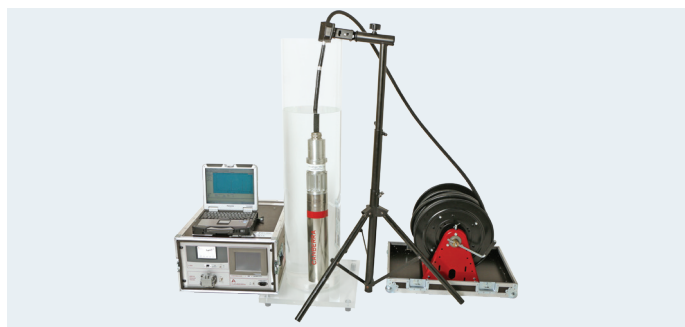
GeHP scellé avec station de mesure et dévidoir (câble de 25 m)
