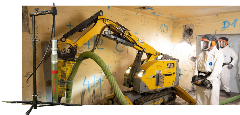
Spectrométrie à cœur pour la détermination des Bq/g à l'aide d'un GeHP scellé sans LN2
