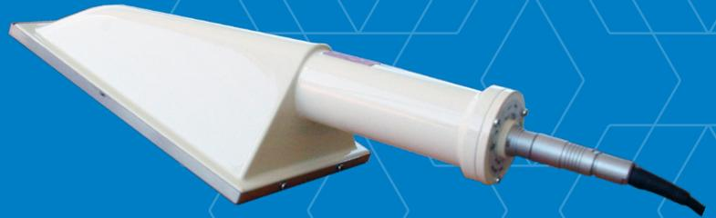
La sonde de mesure de contamination surfacique SAB-250 est conçue pour être utilisée avec tout radiamètre CSP. Son détecteur phoswich de 250 cm<sup>2</sup> de surface de détection en fait l'outil idéal pour la mesure directe des émetteurs alpha et bêta couvrant des applications telles que le poste fixe de surveillance manuelle, la fouille corporelle ou vestimentaire des opérateurs ou le contrôle des grandes surfaces pour les opérations de démantèlement.
